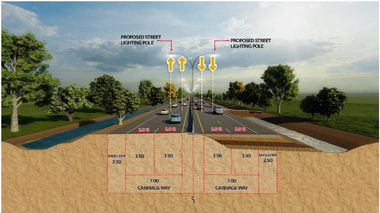
รูปที่ 7-1 รูปแบบทางเลือกที่ 1 เกาะกลางแบบกำแพง (Concrete Barrier Median)
