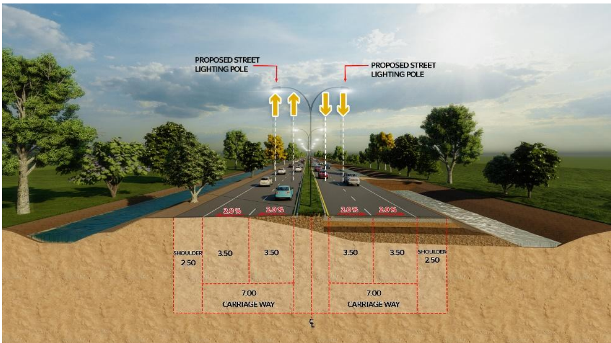
รูปที่ 7-1 รูปแบบทางเลือกที่ 1 เกาะกลางแบบกำแพง (Concrete Barrier Median)
